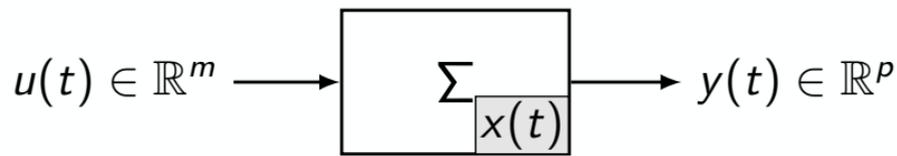
$$y(t) = \underbrace{HF^t x_0}_{\text{evoluzione libera}} + \underbrace{\sum_{k=0}^{t-1} HF^{t-k-1} Gu(k)}_{\text{evoluzione forzata}} = HF^t x_0 + HR_t u_t$$
