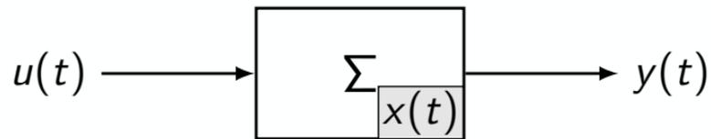
**Osservabilità** = possibilità di determinare lo **stato iniziale**  $x_0 = x(t_0)$  del sistema a partire da misure di ingresso e uscita nell'intervallo  $[t_0, t^*]$
