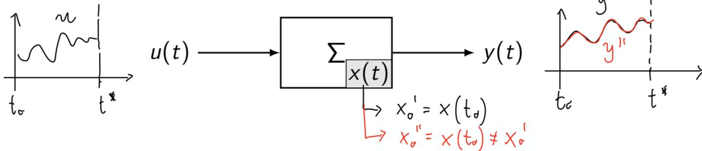
**Definizione:** Uno stato  $x_0'$  si dice indistinguibile dallo stato  $x_0''$  in  $[t_0, t^*]$  se, per ogni ingresso  $u(\cdot)$ , l'uscita  $y'(\cdot)$  corrispondente allo stato iniziale  $x(t_0) = x_0'$  e l'uscita  $y''(\cdot)$  corrispondente allo stato iniziale  $x(t_0) = x_0''$  coincidono su  $[t_0, t^*]$ .
