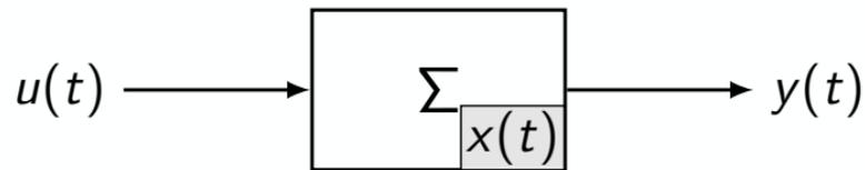
**Definizione:** Uno stato  $x'_0$  si dice indistinguibile dallo stato  $x''_0$  in  $[t_0, t^*]$  se, per ogni ingresso  $u(\cdot)$ , l'uscita  $y'(\cdot)$  corrispondente allo stato iniziale  $x(t_0) = x'_0$  e l'uscita  $y''(\cdot)$  corrispondente allo stato iniziale  $x(t_0) = x''_0$  coincidono su  $[t_0, t^*]$ .
