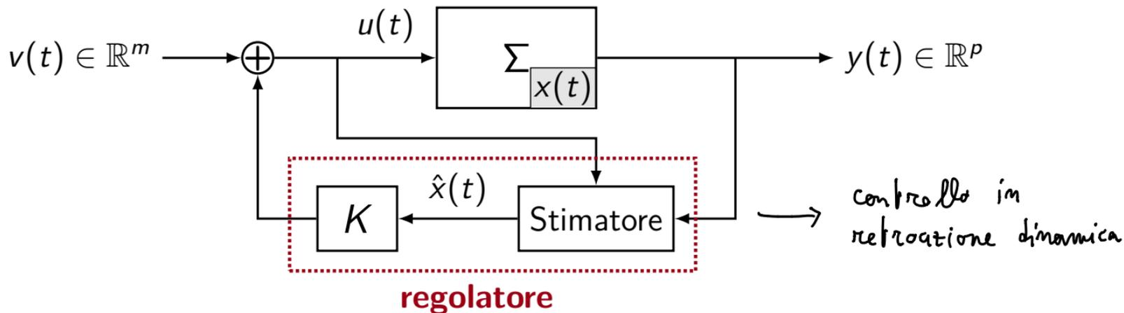
= stimatore dello stato + controllo in retroazione dallo stato
