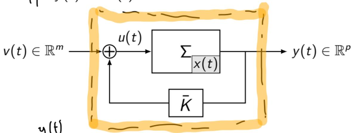
$$u(t) = \underbrace{\bar{K}Hx(t)}_{y(t)} + v(t), \quad \bar{K} \in \mathbb{R}^{m \times p} \quad \text{retroazione statica dall'uscita}$$
