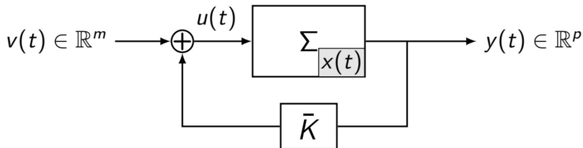
$$u(t) = \bar{K} \overbrace{Hx(t)}^{y(t)} + v(t), \quad \bar{K} \in \mathbb{R}^{m \times p} \quad \text{retroazione statica dall'uscita}$$
