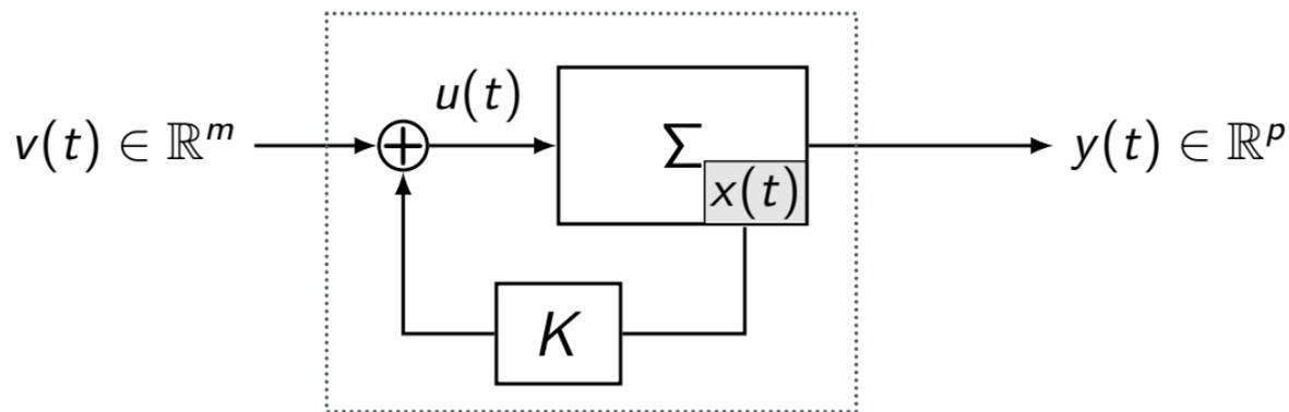
$$u(t) = Kx(t) + v(t), \quad K \in \mathbb{R}^{m \times n} \quad \text{retroazione statica dallo stato}$$
