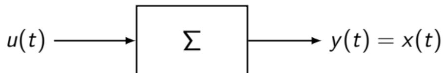
**Definizione:** Uno stato  $x_0$  si dice controllabile allo stato  $x^*$  al tempo  $t^*$  se esiste un ingresso  $u(t)$ ,  $t_0 \leq t \leq t^*$ , tale che  $x(t_0) = x_0$  e  $x(t^*) = x^*$ .
